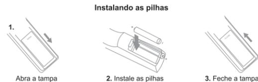
Remova a tampa da bateria do controle e, coloque duas pilhas modelo AAA. O desenho acima exibe a maneira correta de instalar as pilhas.
