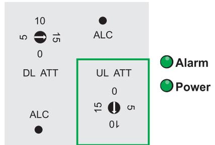
3. Gire o parafuso de ajuste com o seta indicando para a posição (15) (reduziremos 15 dB do ganho total do repetidor conforme indica a tabela), se por exemplo a pessoa do outro lado da linha notar que a sua voz chega com interferência (chiados, voz robotizada, cortada) esse não é o ajuste ideal para seu repetidor, retorne o parafuso de ajuste para a posição (10), este será o ajuste correto do atenuador de seu repetidor Aquário.
