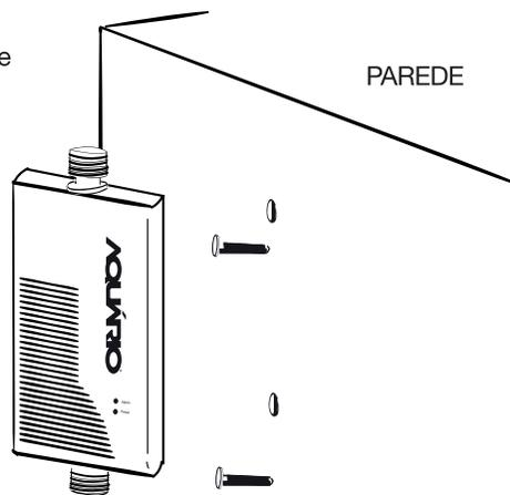
Você ainda pode escolher outras locações para instalar o seu Mini Repetidor, como uma mesa ou estante. Não importa onde você instale, não esqueça de fixar o Mini Repetidor, e deixar a antena interna na posição vertical.
