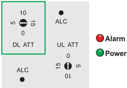
2. Gire o parafuso de ajuste com o seta indicando para a posição (10) (reduziremos 10 dB do ganho total do repetidor conforme indica a tabela), se o Led alarm não ficar na cor verde passe para o passo 3.
