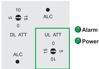
2. Gire o parafuso de ajuste com o seta indicando para a posição (10) (reduziremos 10 dB do ganho total do repetidor conforme indica a tabela), verifique com a pessoa do outro lado da linha se sua voz chega com interferência (chiados, voz robotizada, cortada) caso não haja alteração passe para o passo 3.
