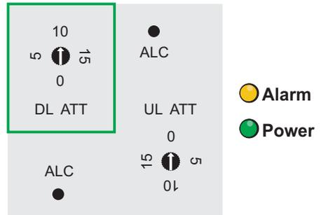
3. Gire o parafuso de ajuste com o seta indicando para a posição (15) (reduziremos 15 dB do ganho total do repetidor conforme indica a tabela), caso o Led alarm fique verde, este será o ajuste correto do atenuador.
