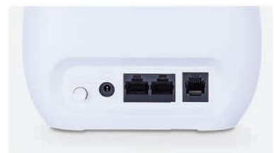
Entradas RJ-45 e RJ-11
