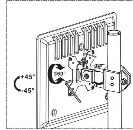
Se o monitor estiver mais baixo, remova a porca e gire o parafuso no sentido anti-horário com a chave Allen fornecida (m) para levantar o monitor e instale a porca após o ajuste
