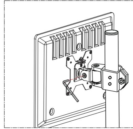
Ajuste e aperte o parafuso com a chave Allen fornecida (m) para fixar o ângulo
