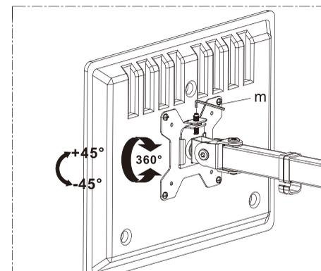
Se o monitor estiver mais baixo, remova a porca e gire o parafuso no sentido anti-horário com a chave Allen fornecida (m) para levantar o monitor. Instale a porca depois de finalizar o ajuste.
