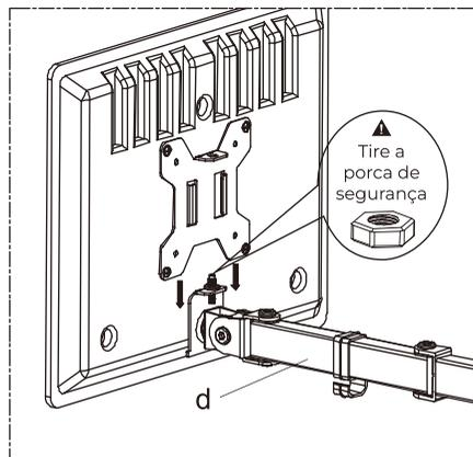
Deslize o monitor para a cabeça do braço giratório (b) como no diagrama acima.
