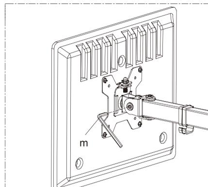
Ajuste e aperte o parafuso com a chave Allen fornecida (m), para fixar o ângulo.
