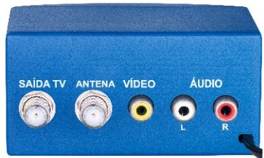
A função de um modulador de áudio e vídeo é converter estes sinais e modulá-los em uma frequência de um canal de TV para ser enviado via cabo de antena. Assim podemos, por exemplo, enviar via cabo de antena, o sinal de alguns equipamentos que possuam saída de áudio e/ou vídeo como por exemplo: Receptor de antena parabólica, DVD, DVR de um sistema de CFTV, Mídia player, conversor digital etc.
