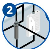
Conecte a antena externa ao repetidor e, então, ao divisor
