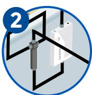
Conecte a antena externa ao repetidor e, então, ao divisor
