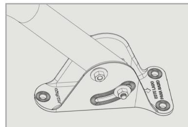
**8.** Encaixe o mastro pela parte de trás da antena. Observe que no local há uma braçadeira que já vem parafusada ao corpo da antena. É só afasta-la ligeiramente, encaixar o mastro e ajustar os parafusos com auxílio da chave de fenda.
