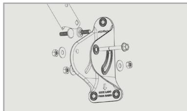
**4.** Prenda o mastro ao suporte de parede, usando o parafuso de fixação. Encaixe-o no orifício lateral do suporte e atravesse-o até o lado oposto.
