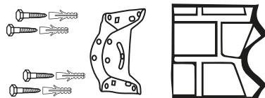
3 - Monte os parafusos que seguram o tubo observando que a extremidade deste fique na vertical, (exatamente 90° em relação ao solo).
