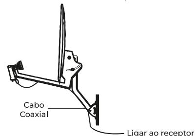
7 - Gire a antena direcionando-a ao azimute anotado anteriormente no passo 1. Para isso utilize uma bússola.
