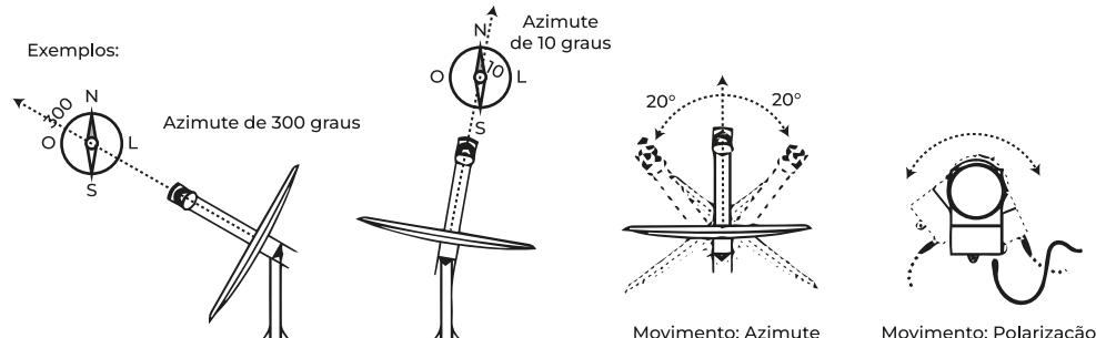
6 - Fixe o LNBF no suporte da antena (deixando-o na angulação obtida no passo 1) conectando o cabo coaxial uma ponta no LNBF e a outra ponta na entrada de antena do receptor.
