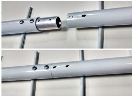
**2.** Utilizando uma chave “Philips” insira e aperte os parafusos até que as partes fiquem totalmente fixas como mostra figura abaixo.
