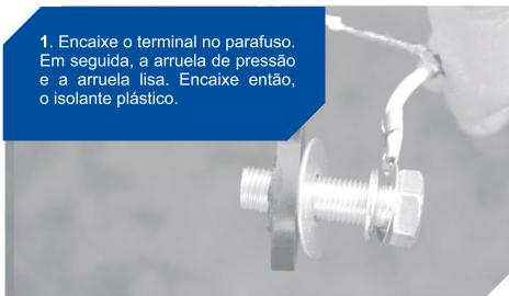
1. Encaixe o terminal no parafuso. Em seguida, a arruela de pressão e a arruela lisa. Encaixe então, o isolante plástico.
