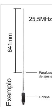
**ATENÇÃO:** A Tabela de corte é para início de ajuste e é recomendado que o ajuste de frequência e VSWR seja feito utilizando um medidor de ondas estacionárias, pois a medida da haste pode variar devido alguns fatores como: a qualidade do plano terra, a proximidade da lataria do veículo etc. Sempre faça o ajuste aos poucos, medindo a ROE em frequências mais altas e mais baixas que a frequência desejada e corte a haste da antena aos poucos, caso necessário.
